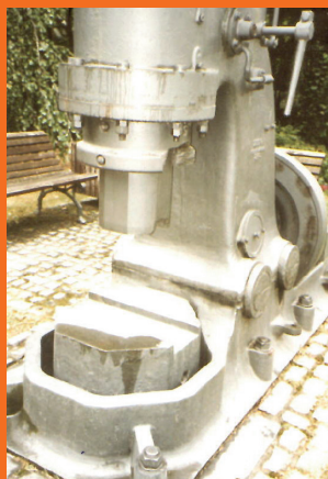
Lufthammer der Firma Beche, aufgestellt in Warstein als Industriedenkmal (Maschinen dieser Baureihe wurden bei Busch in der Gesenkschmiede eingesetzt).
