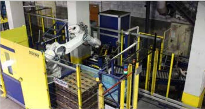
Kern der Anlage ist ein Roboter, der die Bremsscheiben vom Rollband nimmt und einer Verpackungseinheit zuführt. Jede einzelne Scheibe wird dabei durch eine Kamera geprüft. Diese Kamera registriert, wenn eine Scheibe nicht zum vorherigen Programm passt und ändert dann automatisch das Verpackungsprogramm.
