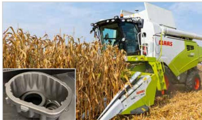
▲ Das gratfrei gegossene Gehäuse von Busch soll für die Achsen des Nachfolgemodells des Tucano verwendet werden.
