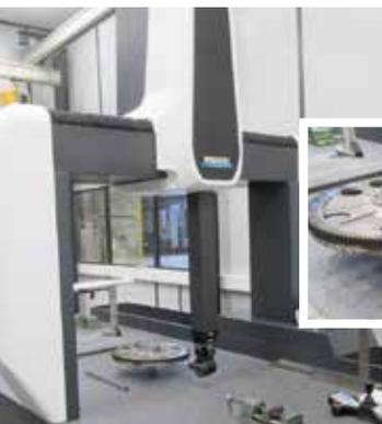
Zur Realisierung des MDEG-Projektes für Daimler wurde eine neue Koordinaten-Messmaschine angeschafft. Die Firma Wenzel Präzision GmbH aus Wiesthal in Bayern hat diese neue Messanlage geliefert und installiert.
