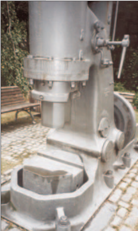
Lufthammer der Firma Beche, aufgestellt in Warstein als Industriedenkmal (Maschinen dieser Baureihe wurden bei Busch in der Gesenkschmiede eingesetzt)
