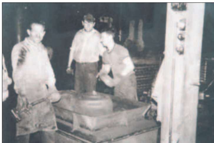
Trennen von Guss und Sand am Rüttelrost
