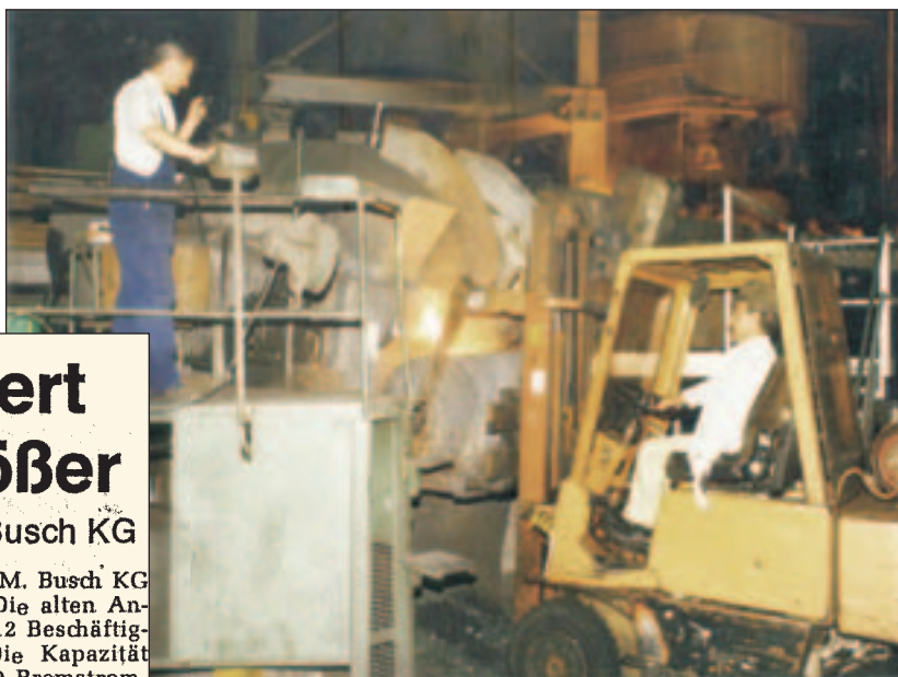
Flüssigeisen wird aus dem Warmhalteofen in eine Gießpfanne gefüllt
