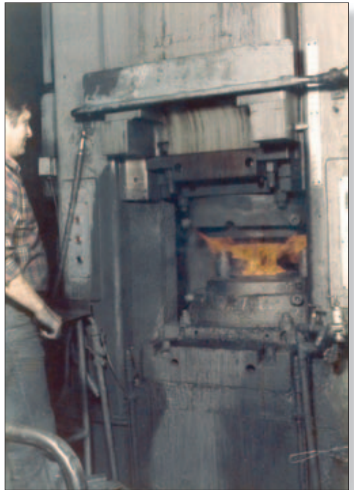
Hydraulische Gesenkpresse von Hasenclever in der Schmiede in Bestwig
