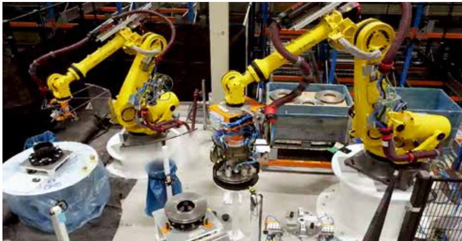
Montage der Bremscheiben auf die Naben
