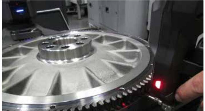
▲ Der 3-D-Messtaster im Einsatz – für hochpräzise Messungen vor Ort.
